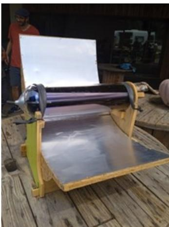
**Le tube solaire** : un four cylindrique fonctionnant uniquement à l'énergie solaire, idéal pour cuire des légumes ou des cakes salés ou sucrés. Il s'agit d'un tube en pyrex captant le rayonnement solaire grâce à un revêtement sombre extérieur.
